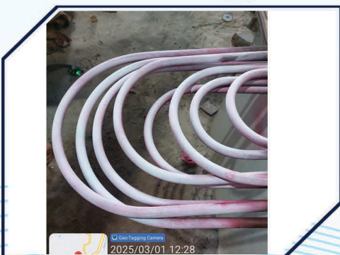
U Bend LPT Test
